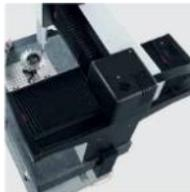
Faltenbälge an X- und Y-Achse schützen das Gerät vor eindringendem Staub und Schmutz.
