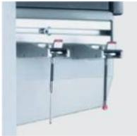
Tasterwechsler für HP-S-X1 im Maschinenrahmen integriert. Eigens entwickelte Abdeckungen schützen die HP-S-X1 Taster vor Staub und Schmutz.
