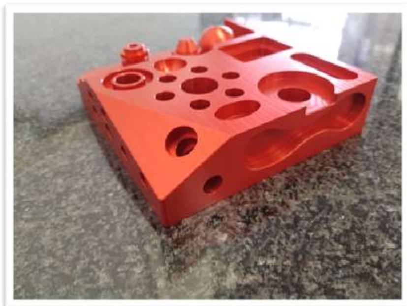
*2D Freiformkontur um Scaningübungen durchzuführen und Linienprofile auszugeben*
